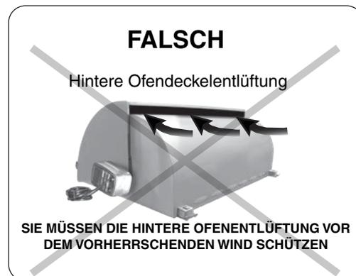
Abb. 11-4 Richtung des Luftstroms - FALSCH
